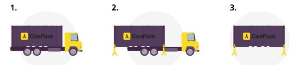
Während der Container auf den Stützen steht und an der Laderampe befestigt ist, ist es ebenfalls möglich diesen mit einem Stapler zu be- und entladen.
